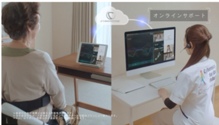
HALは、サイバーダイナミクスクラウドとデータ連動しており、身体動作を指令する生体電位信号や姿勢情報等を可視化し、装着者自身が視覚的にフィードバックを得ることができるだけでなく、データ解析結果に基づき、利用者一人一人に合わせたプログラムのカスタマイズも可能。
