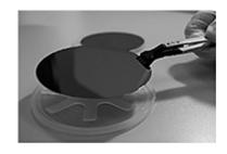
様々な光デバイス・電子デバイス用途に、カスタマイズした分子線エピタキシー(MBE)装置を用いたGaAs基板上の高品質エピタキシャルウェハです。量子ドットウェハには、テレコム/データコム用温度安定レーザや、220 までの高温度環境で動作するレーザで、世界最高水準の量子ドット技術が適用されております。
