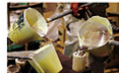
砂型へのアルミニウム合金の鑄込み
