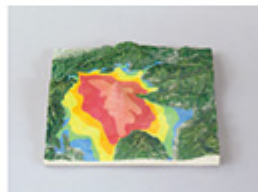
③粉末固着(石膏造形)方式で作製した造形品
