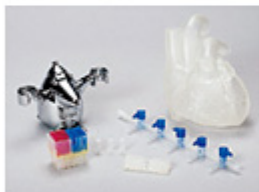
①光造形方式で作製した造形品
