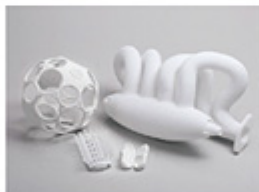
②粉末焼結(ナイロン造形)方式で作製した造形品
