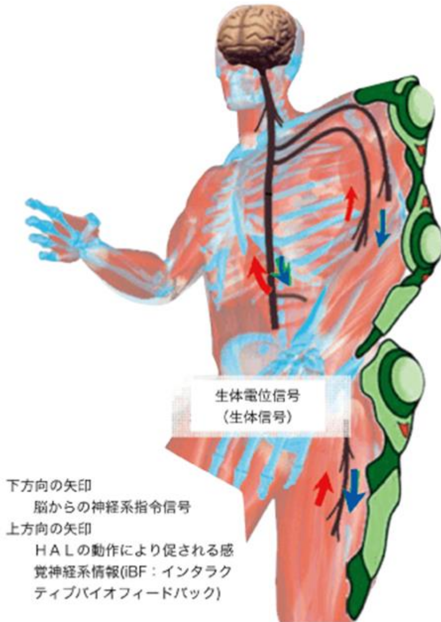
図3 ロボットスーツHALの制御方法
